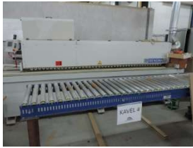
Kavel 4 Tecnomat Kantenlijmer BT5 kant aanlijm machine kapzagen met 2 motoren freesstation hoek afrond unit - lijm schraper - radius schraper – poetsunit bouwjaar 2010
